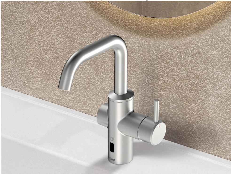
La nueva grifería para zonas de lavado híbrido F5 puede abrirse como de costumbre mediante la palanca de mando, y se pueden ajustar las temperaturas preferidas. Alternativamente, un movimiento de la mano delante del sensor es suficiente para iniciar el flujo de agua con la temperatura de mezcla preestablecida.
