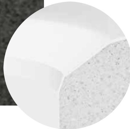
MIRANIT est une combinaison solide composée d'env. 80 % de minéraux naturels comme la poudre de marbre, le grès et le sable quartzique et d'env. 20 % d'une résine polyester haut de gamme non saturée. Grâce à ses excellentes propriétés d'écoulement, ce matériau à liant en résine synthétique peut être moulé dans la quasi-totalité des formes au choix, même avec une faible épaisseur de matériau.
