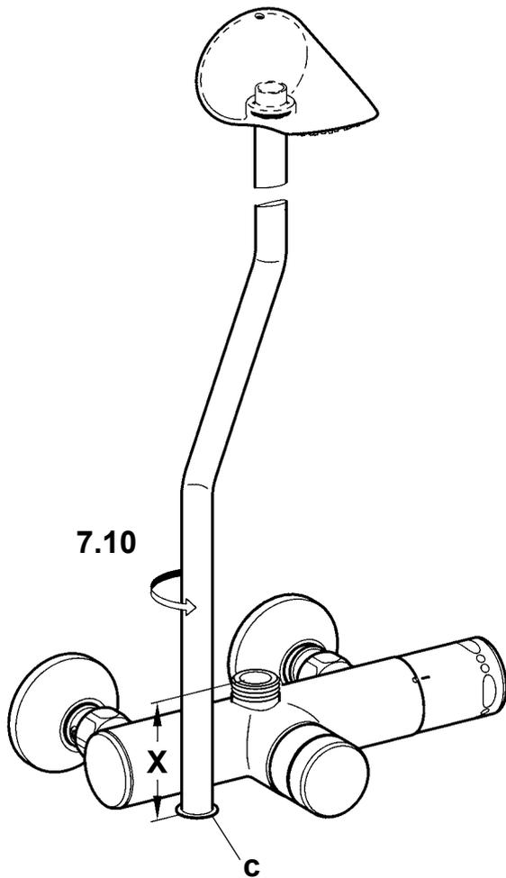
7.10 Das Duschrohr möglichst nah an die Armatur drehen.
