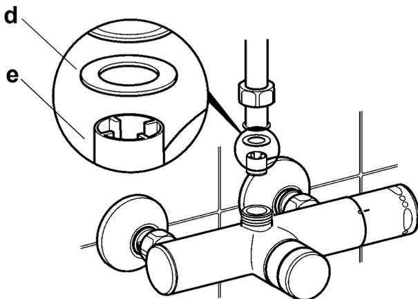
7.15 Den Durchflussmengenregler (e) und die Dichtung (d) in die Armatur einsetzen.
