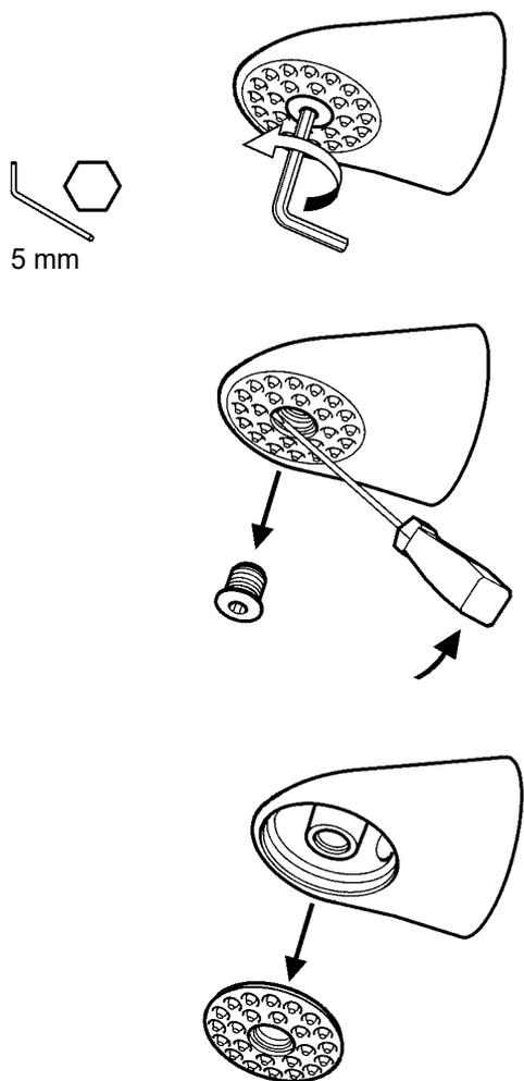
9.1 Die Schraube mit einem Innen-sechskant-Schlüssel lösen.
