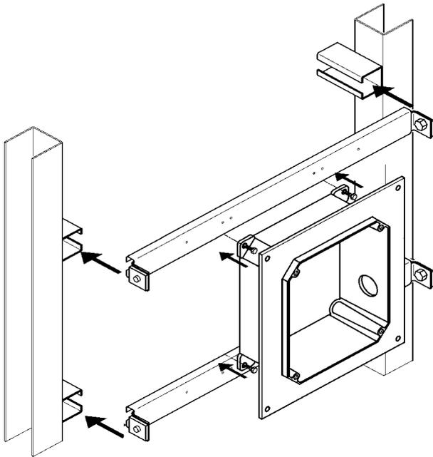
4.4 Den Wandeinbaukasten mit den Sechskantbohrschrauben an den Traversen verschrauben.
