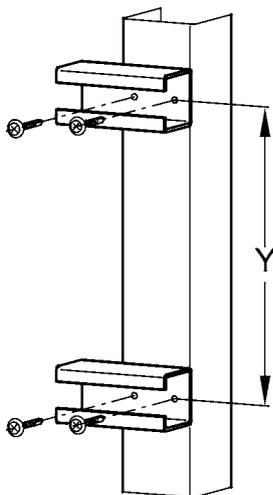
4.1 Das Maß Y nach dem gewünschtem Wandeinbaukasten wählen; entweder 174 mm, 200 mm oder 305 mm.
