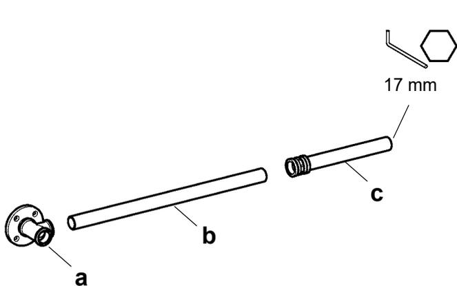
**10.1** Das Verbindungsrohr (b) dichtend in die Wandplatte (a) schrauben.
