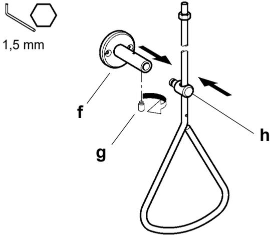
**10.10** Die Führungsstütze (f) auf die Führung (h) an der Handbetätigung stecken und mit dem Gewindestift (g) sichern.
