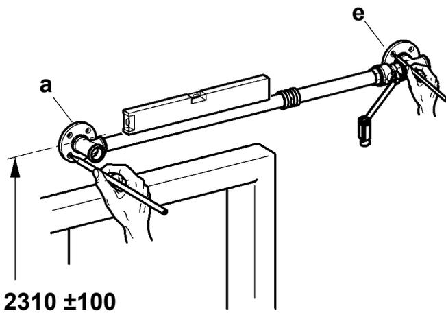
☞ Ab einer Türblattbreite von 1 m ist zu prüfen, ob die Türzarge eine Montage von Zugstange oder Wandstütze behindert.
