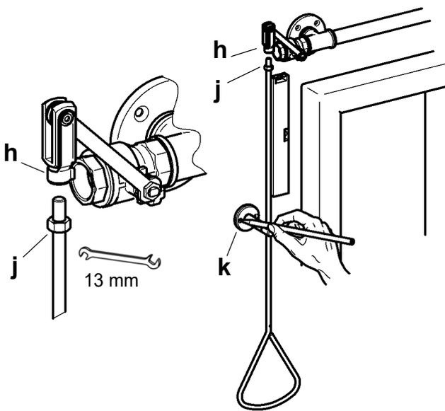
**11.11** Die Handbetätigung (j) in den Gabelkopf (h) vom Umlenkhebel schrauben und mit einer Mutter kontern.
