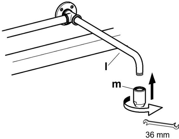
11.18 Den Duschkopf (m) dichtend an den Wandarm (l) schrauben.
