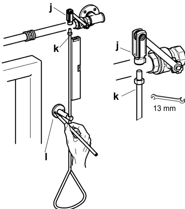
**10.12** Die Handbetätigung (k) in den Gabelkopf (j) vom Umlenkhebel schrauben und mit einer Mutter kontern.
