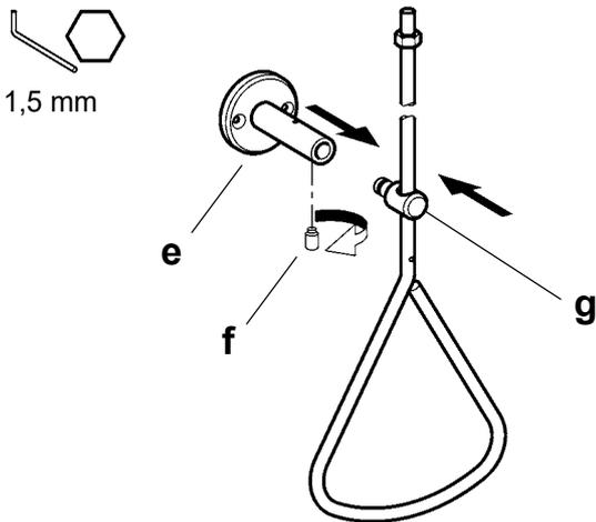
**11.9** Die Führungsstütze (f) auf die Führung (h) an der Handbetätigung stecken und mit dem Gewindestift (g) sichern.
