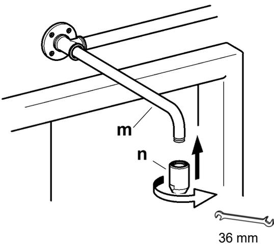
**10.19** Den Duschkopf (n) dichtend an den Wandarm (m) schrauben.
