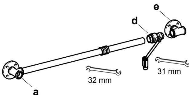
**10.3** Den geschlossenen Kugelhahn (d) dichtend möglichst weit einschrauben und so in Stellung bringen:
