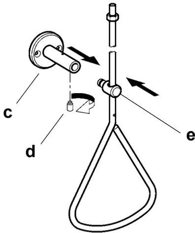
**10.3** Die Führungsstütze (c) auf die Führung (e) an der Handbetätigung stecken und mit dem Gewindestift (d) sichern.
