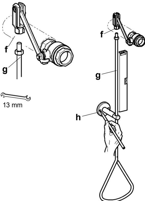
**10.5** Die Handbetätigung (g) in den Gabelkopf (f) vom Umlenkhebel schrauben und mit einer Mutter kontern.
