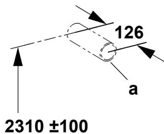
**10.1** Die Wasserzuführung (a) in einer Höhe von  $2310 \pm 100$  mm über Fertigfußboden ausrichten.
