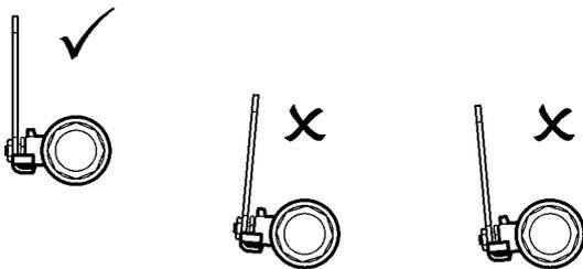
**10.2** Den geschlossenen Kugelhahn dichtend möglichst weit einschrauben und so in Stellung bringen:
