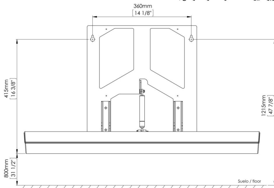
بناء على الرسم السابق، قم باستخدام القلم الرصاص لتحديد أماكن ثقب الجزء العلوي لهيكل تثبيت سرير تغيير الحفاضات على الحائط. من المهم جداً التأكد من أن الأماكن التي قد تم تحديدها بالقلم الرصاص لثقب التركيب تقع على المستوى نفسه قبل عمل الثقب.
