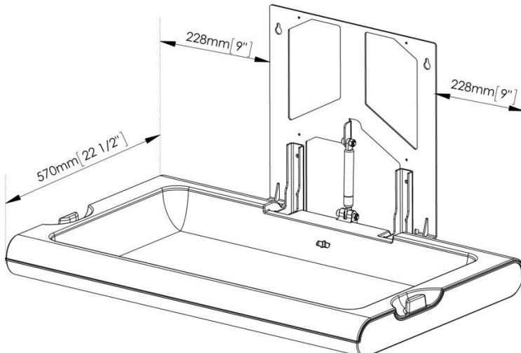
A altura recomendada de instalação é de 800 mm, partindo do solo até à parte mais baixa do trocador de fraldas. O esquema a seguir mostra a que altura se devem realizar os furos para que o trocador de fraldas fique instalado à altura recomendada:
