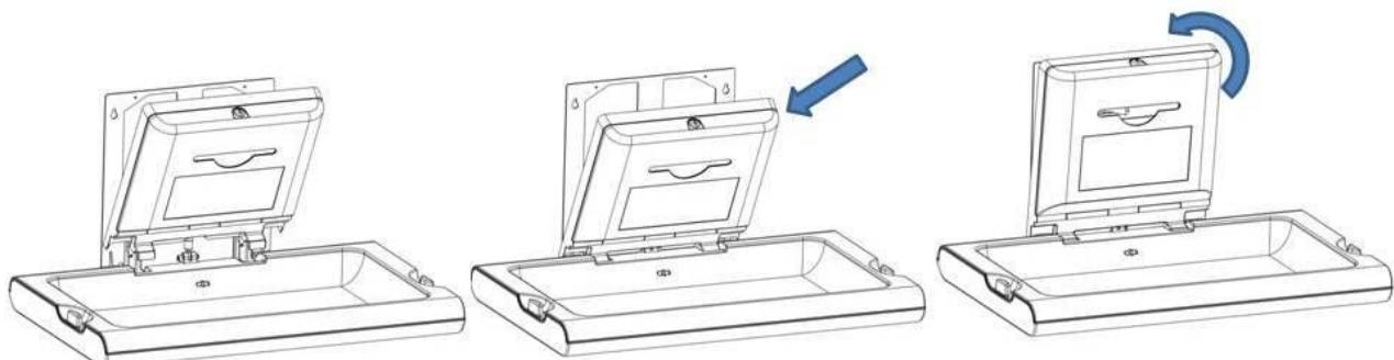
Abrir el dispensador de sábanas con la llave especial suministrada. Los cuatro orificios de fijación de este dispensador de sábanas a la estructura de sujeción del cambiador quedarán a la vista.
