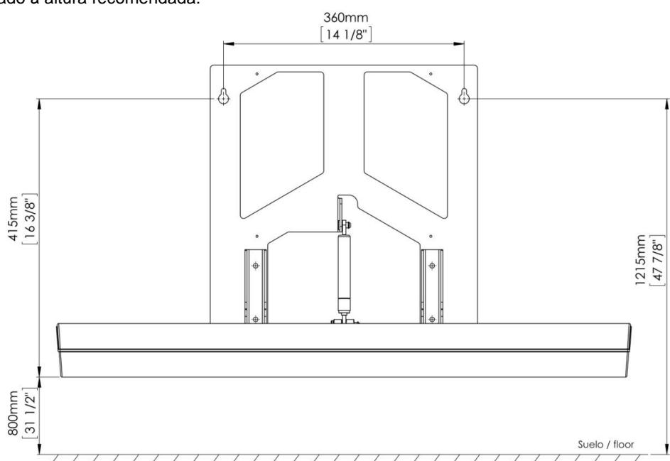
Seguindo o esquema anterior marque em cima da parede os furos superiores da estrutura de fixação do trocador de fraldas com o lápis. É muito importante assegurar que as localizações marcadas com o lápis para os furos de montagem estão no mesmo nível que antes de realizar as perfurações.
