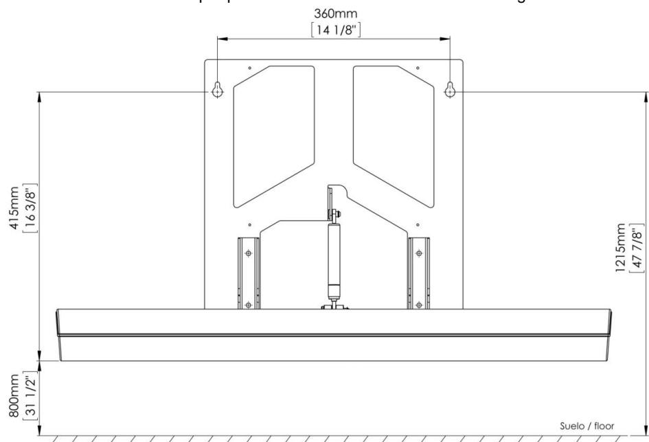
In base al disegno precedente tracciare a matita, sulla parete, i punti in cui realizzare i due fori superiori della struttura di fissaggio del fasciatoio. Prima di trapanare, è fondamentale verificare che i punti dei fori di montaggio tracciati a matita si trovino alla stessa altezza.
