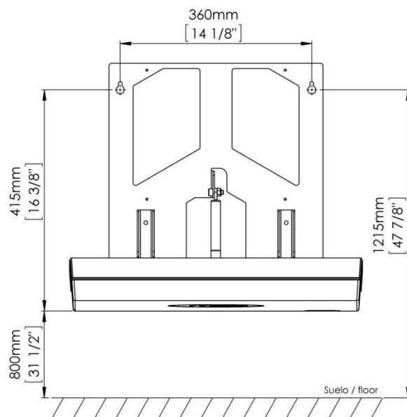
بناء على الرسم السابق، قم باستخدام القلم الرصاص لتحديد أماكن ثقب الجزء العلوي لهيكل تثبيت سرير تغيير الحفاضات على الحائط. من المهم جدًا التأكد من أن الأماكن التي قد تم تحديدها بالقلم الرصاص لثقب التركيب تقع على المستوى نفسه قبل عمل الثقب.
