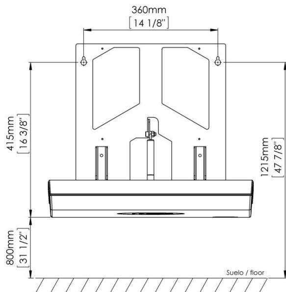
Nach der gleichen Vorgehensweise markieren Sie an der Wand mit dem Bleistift die zwei Stellen, an denen die oberen Löcher für die Halterung gebohrt werden sollen. Achten Sie vor dem Bohren darauf, dass die Positionen für die Löcher auf gleicher Höhe sind.
