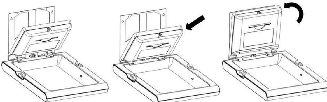
Abrir el dispensador de sábanas con la llave especial suministrada. Los cuatro orificios de fijación de este dispensador de sábanas a la estructura de sujeción del cambio pañales quedarán a la vista.
