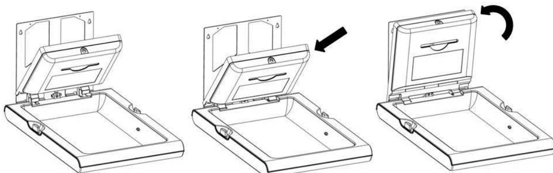
Abrir el dispensador de toalhinhas con la llave especial suministrada. Los cuatro orificios de fijación de este dispensador de toalhinhas a la estructura de fixação del trocador de fraldas quedarán a la vista.
