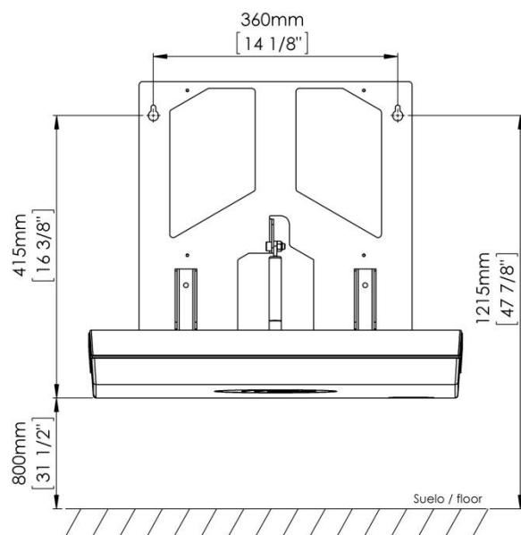
En suivant le schéma antérieur, marquer à l'aide d'un crayon sur le mur les deux trous supérieurs de la structure de fixation de la table à langer. Il est important de s'assurer que les emplacements marqués au crayon pour les trous de montage soient au même niveau avant de percer.
