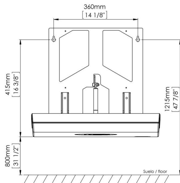
Siguiendo el esquema anterior marcar con el lápiz, sobre la pared, los dos agujeros superiores de la estructura de sujeción del cambia pañales. Es muy importante asegurar que las ubicaciones que se hayan marcado a lápiz para los agujeros de montaje estén al mismo nivel antes de realizar las perforaciones.
