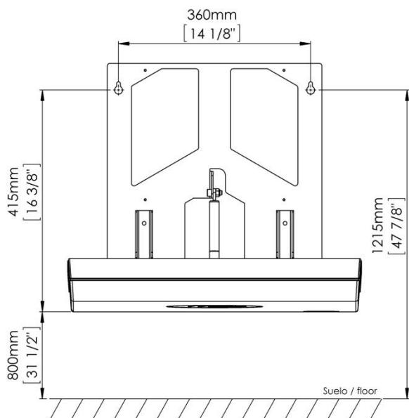
Seguindo o esquema anterior marque em cima da parede os furos superiores da estrutura de fixação do trocador de fraldas com o lápis. É muito importante assegurar que as localizações marcadas com o lápis para os furos de montagem estão no mesmo nível que antes de realizar as perfurações.
