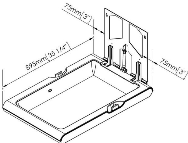
A altura recomendada de instalação é de 800 mm, partindo do solo até à parte mais baixa do trocador de fraldas. O esquema a seguir mostra a que altura se devem realizar os furos para que o trocador de fraldas fique instalado à altura recomendada:
