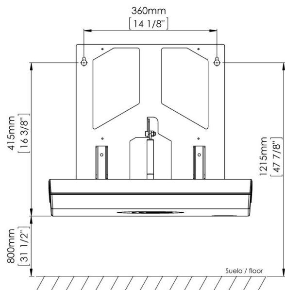
In base al disegno precedente tracciare a matita, sulla parete, i punti in cui realizzare i due fori superiori della struttura di fissaggio del fasciatoio. Prima di trapanare, è fondamentale verificare che i punti dei fori di montaggio tracciati a matita si trovino alla stessa altezza.
