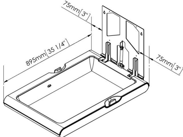
La altura recomendada de instalación es de 800 mm desde el suelo hasta la parte más baja del cambia pañales. El croquis siguiente muestra a qué altura deben realizarse los agujeros para que el cambia pañales quede instalado a la altura recomendada:
