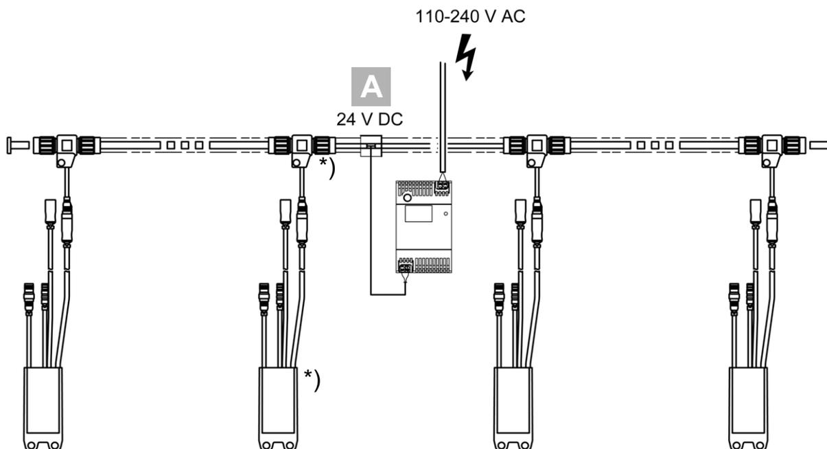
\*) Die Platzierung der A3000open-Komponenten ist abhängig vom zur Verfügung stehenden Bauraum der jeweiligen Armatur.
