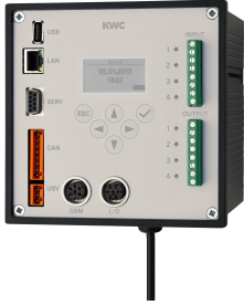
ECC2 function controller
